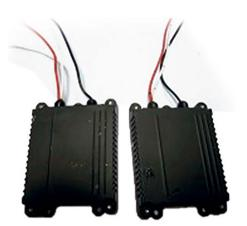
Resistenza per lampadine a Led ausiliari, aumenta l'assorbimento di corrente per evitare
