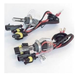
Lampada per Kit Xeno per mezzi a 12V completo di connettori, abbinandola al Ballast specifico è possibile comporre il Kit Xeno HID nella versione desiderata
