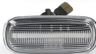
Frecce laterali a LED con lente chiara per un look più moderno\_x000D\_ Montaggio
