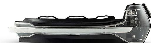
Frecce da specchietto progressivo con lente standard per un look più moderno ma in linea con la vettura originale. Grazie al Canbus integrato e al montaggio plug&play la vostra auto non segnalerà alcun errore dopo l'installazione. Ogni set contiene due frecce dinamiche, una per il lo specchietto sinistro e una per quello destro.
